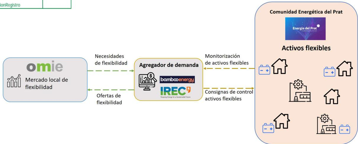
*Figura 3 Esquema de la solución propuesta a implementar*
